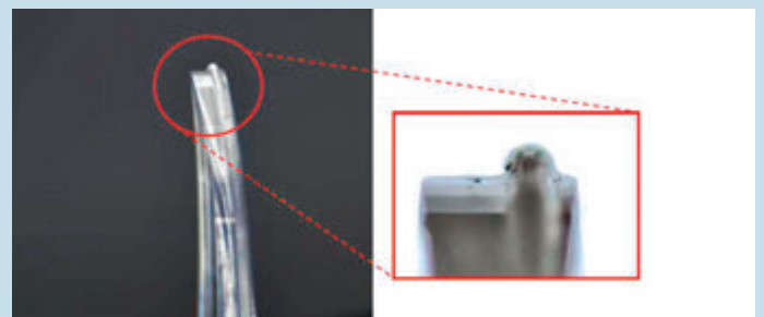
Abb. 12: Elastische Facette mit halbkreisförmiger Kontur.
