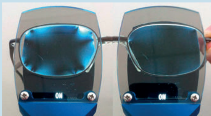
Abb. 13: Vergleich konventionelle Verglasung versus elastische Facette.
