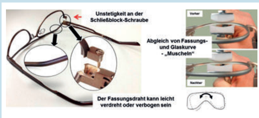
Abb. 2: Torsion des Fassungsdrahts, Unstetigkeiten am Schließblock und Verformungen beim Muscheln der Fassung führen zu Abweichungen.
